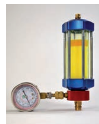
Kältemittel R134a gemischt mit - DENSO ND8 (PAG46) - UV-Lecksuchadditiv - Universalöl (PAO68)
