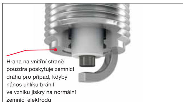
Obr. 7.11 Svíčka pro polopovrchový výboj
