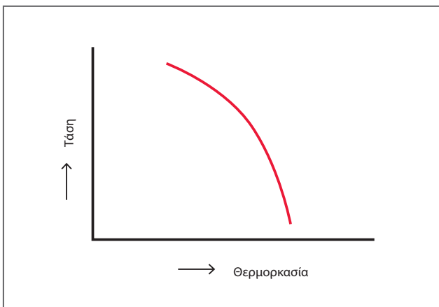
Εικ. 6.7 Η τάση που απαιτείται για τη δημιουργία σπινθήρα μειώνεται με μια αυξημένη θερμοκρασία ηλεκτροδίου
