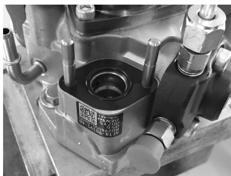
Zwei Führungsstifte in die Befestigungslöcher einsetzen und die neuen Dichtungen montieren
