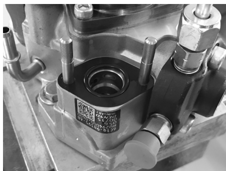
Installer les 2 goupilles de guidage et installer les nouveaux joints
