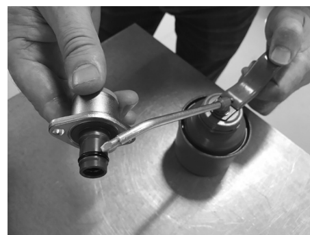
Motoröl auf den kleinen O-Ring auftragen
