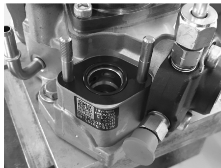
Installare 2 spine di centraggio nei fori di fissaggio della valvola nella pompa e installare una guarnizione nuova
