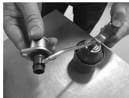
Lubrifier le petit joint torique avec l'huile moteur
