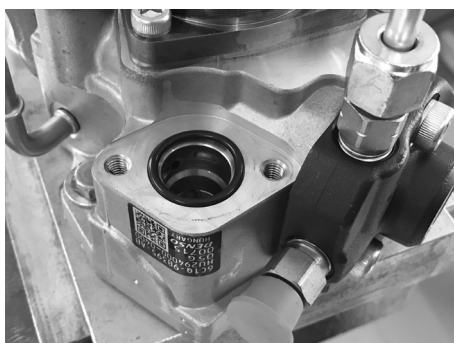
Einbau eines neuen O-Rings
