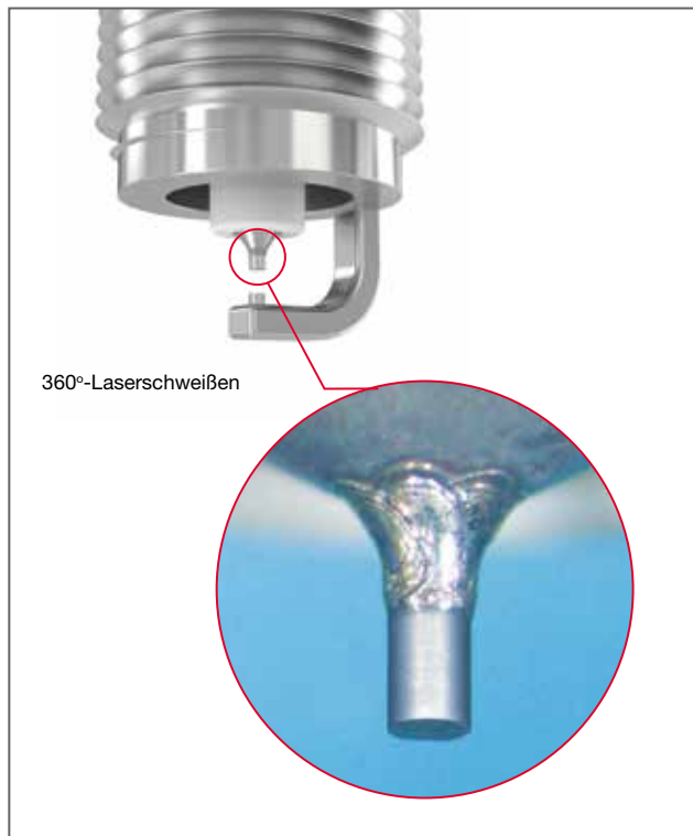
Abb. 7.6 Iridium-Mittelelektrode – 0,4 mm Durchmesser
