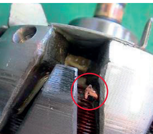
Drahtbruch im Rotor
