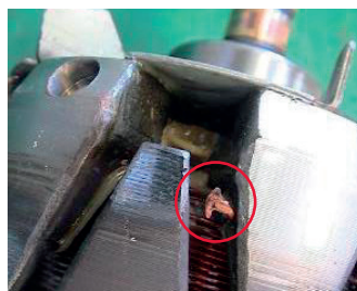
Pęknięcie w uzwojeniu wirnika
