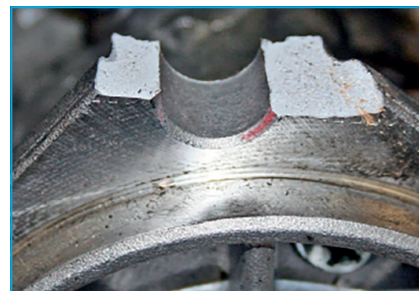
Гнездото на монтажния болт на стартера към двигателя е счупено поради грубо боравене, неправилен монтаж или пренавиване на болта на двигателя.
