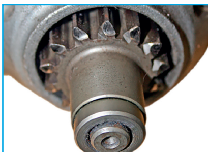
Střední opotřebení opakovaným vysouváním.
