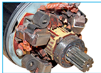
Poškození komutátoru, uhlíků a jejich držáků.
