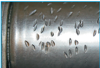
Opakované úderky kladivem či jiným cizím předmětem na pouzdro spínací cívky.
