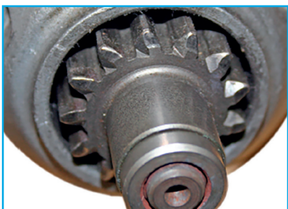
Mírné opotřebení opakovaným vysouváním (způsobí poškození setrvačnicku a problémy při zasouvání pastorku do ozubení věnce setrvačnicku).
