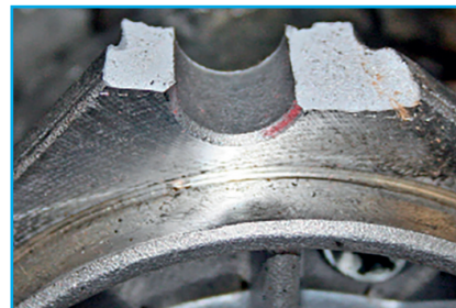
Oko pro montáž startéru na motor je uloženo chybou při opravě, nesprávnou montáží nebo přetažením šroubu.
