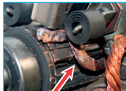
Lamely komutátoru jsou uvolněné, vyvýšené a ohnuté (deformované).
