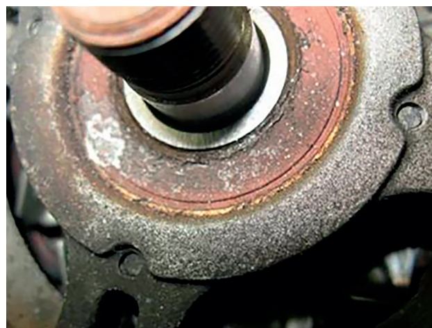
Zkorodované ložisko působením stékající vody.
