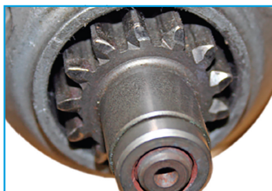
Χαμηλού βαθμού επανασύμπτωση (θα προκαλέσει βλάβη στο βολάν και θα υπάρξει δυσκολία σύμπτωσης με το βολάν).
