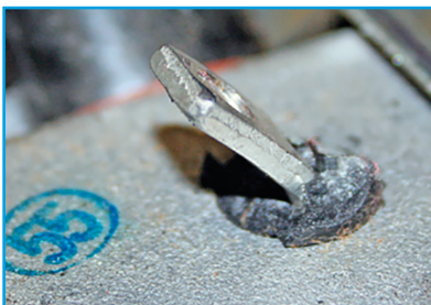
Η ζημιά στον ακροδέκτη μπορεί να προκαλέσει επαφή της γείωσης με το περίβλημα
