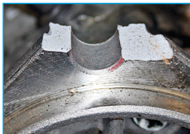
Σπασμένη υποδοχή μπουλονιού συναρμολόγησης στον κινητήρα λόγω κακού χειρισμού, ακατάλληλης τοποθέτησης ή υπέρβασης της ροπής σύσφιξης του μπουλονιού του κινητήρα.
