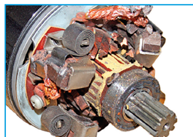
Βλάβη στο μεταγωγέα, τις ψήκτρες και τη διάταξη συγκράτησης της ψήκτρας.
