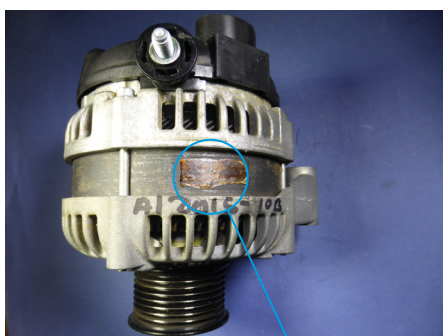
Η ετικέτα ID έχει υπερθερμανθεί και έχει συρρικνωθεί. Αυτό είναι ένα σημάδι υπερβολικής θέρμανσης
