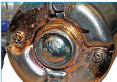
Λιωμένη μόνωση στα μπουλόνια του μπροστινού άκρου του περιβλήματος του εκκινητήρα. Αυτό είναι ένα σημάδι της κακής χρήσης του εκκινητήρα (υπερθέρμανση).
