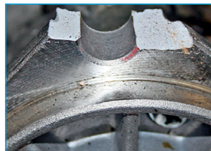
Deformirani provrt za montažni vijak koji spaja elektropokretač s motorom zbog nepravilnog rukovanja, neispravne ugradnje ili prekomjernog zatezanja vijka motora.
