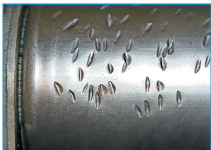
Pokrov solenoida više puta je udaren čekićem ili drugim stranim predmetom.
