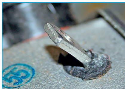
Oštećenje stezaljke može uzrokovati kontakt s uzemljenjem kućišta.
