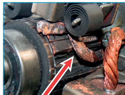
Segmentna šipka kolektora se odvojila, podigla i svinula (iskrivila).
