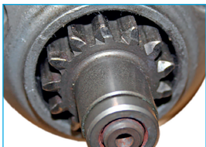
Neznatno ponovno uzublivanje (uzrokuje oštećenje zamašnjaka i teško uzublivanje u zamašnjak).
