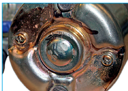
Rastopljena izolacija prolaznih vijaka na krajnjem poklopcu elektropokretača. To je znak zlouporabe elektropokretača (pregrijao se).
