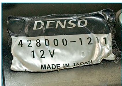
Identifikacijska pločica se pregrijala i smanjila. To je znak prevelike vrućine.
