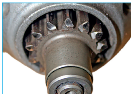
Umjereno ponovno uzublivanje malog zupčanika.
