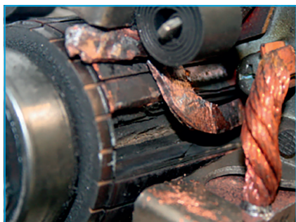
Izlizana površina kolektora. Svinute segmentne šipke kolektora.
