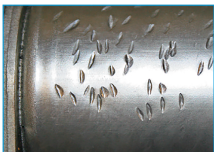
A tekercsházat többször megütötték kalapáccsal vagy idegen testtel.
