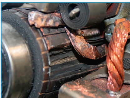
A kommutátor felülete szennyezett. A kommutátor szegmensek elhajlottak.
