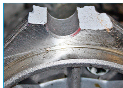
Az indítómotort rögzítő csavar furata kitért a nem megfelelő beépítés, kezelés vagy nyomaték miatt.
