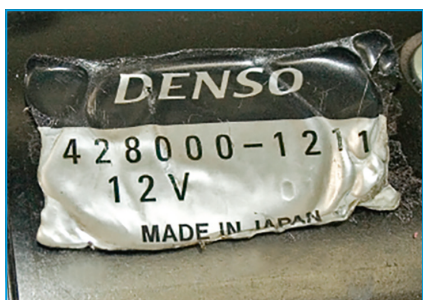
Az azonosító matrica leolvadt és levált. Ez magas hőre utal.
