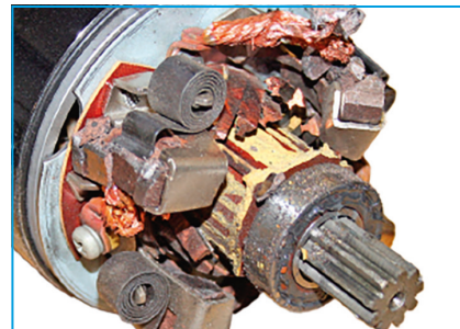
Kommutátor, szénkefe, szénkefe tartó meghibásodás.
