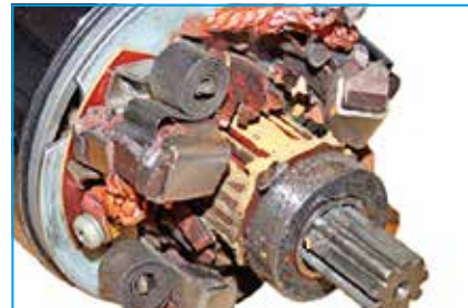
Deteriorarea colectorului, periilor și suportului pentru perii.
