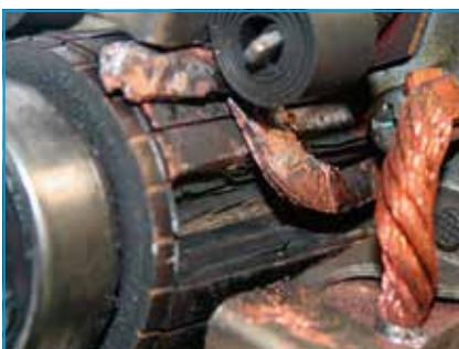
Suprafața colectorului devine sticloasă. Barele colectorului sunt îndoite.
