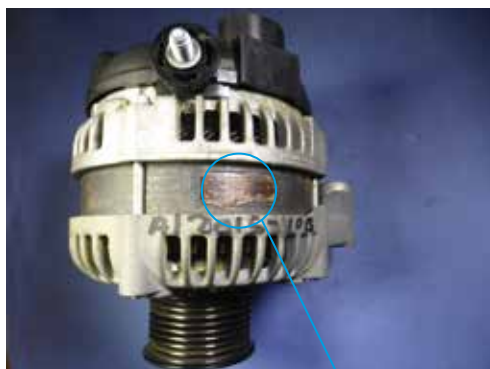
Eticheta de identificare s-a supraîncălzit și s-a contractat. Acesta este un semn de încălzire excesivă
