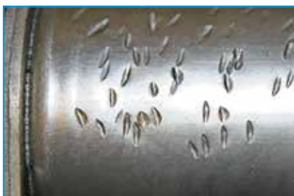
Capacul solenoidului a fost lovit în mod repetat cu un ciocan sau cu un obiect străin.
