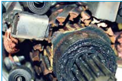
Segmentele colectorului sunt dezlipite.
