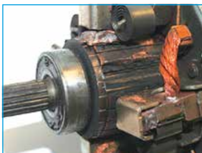
Suprafața colectorului este arsă. Barele colectorului lipsesc.
