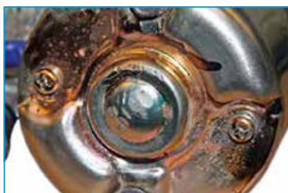
Izolația topită a șuruburilor de fixare a carcasei demarorului. Acesta este un semn de utilizare abuzivă a demarorului (supraîncălzire).
