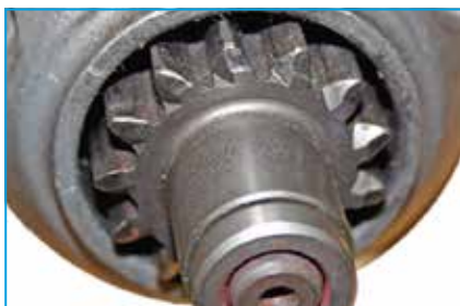
Problemă minoră în caz de recuplare (va conduce la deteriorarea volantului și la dificultăți de cuplare cu volantul).
