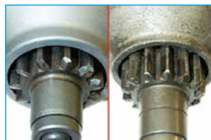
Demaror normal (stânga), pinion de angrenare retras complet. Demaror supraîncălzit (dreapta), pinionul de angrenare nu este retras complet. Supraîncălzirea afectează tensiunea arcului de revenire.
