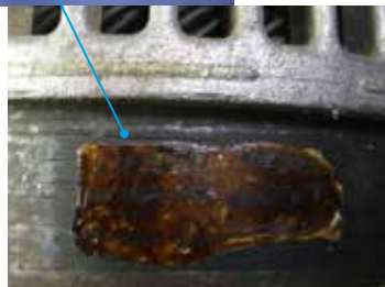
Eticheta de identificare s-a supraîncălzit și s-a contractat. Acesta este un semn de încălzire excesivă
