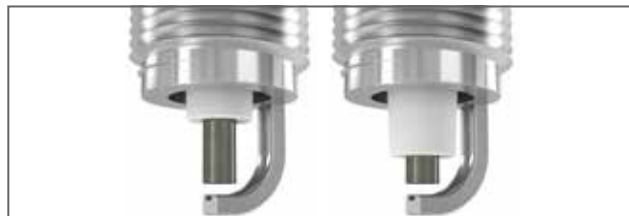
Kuva 7.16 Pidentetyt tai ulkonevat elektrodit
