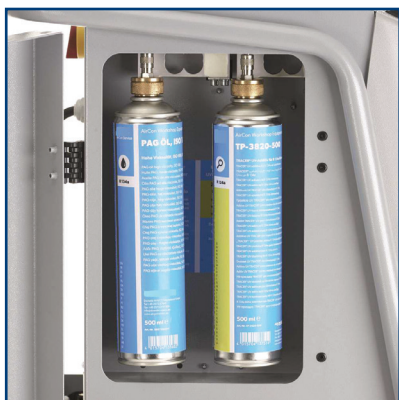
System podawania oleju bez wilgoci
