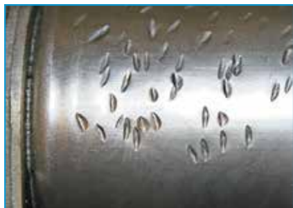
Pokrywa cewki cylindrycznej została wielokrotnie uderzona młotkiem lub innym przedmiotem.
