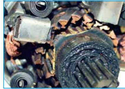
Oddzielone segmenty komutatora.
