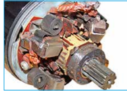
Uszkodzenia komutatora, szczotek i szczotkotrzymacza.
