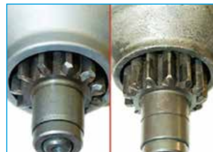
Normalny rozrusznik (po lewej stronie), zębniak całkowicie wycofany. Przegrzany (po prawej stronie), zębniak nie wycofany całkowicie. Przegrzanie ma wpływ na naciąg sprężyny powrotnej.
