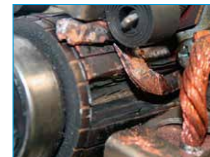
Powierzchnia komutatora ulega zeszkleczeniu. Wygięte pręty segmentów komutatora.
