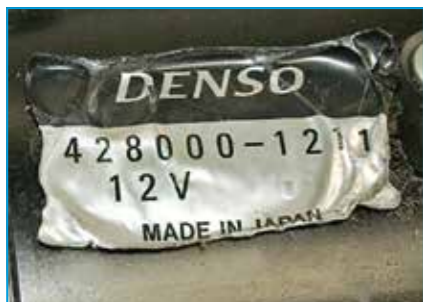
Przegrzanie i skurczenie tabliczki znamionowej. To oznaka nadmiernego ciepła.
