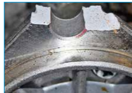
Otwór śruby mocującej rozrusznik do silnika został uszkodzony z powodu nieprawidłowego działania, nieprawidłowej instalacji lub zbyt mocnego dokręcenia śruby silnika.
