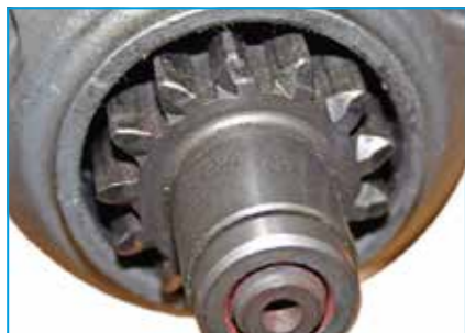
Mały problem z zazębieniem (powoduje uszkodzenia koła zamachowego i trudności z zazębieniem z kołem zamachowym).
