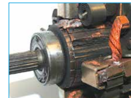
Powierzchnia komutatora jest spalona. Brak prętów segmentów komutatora.
